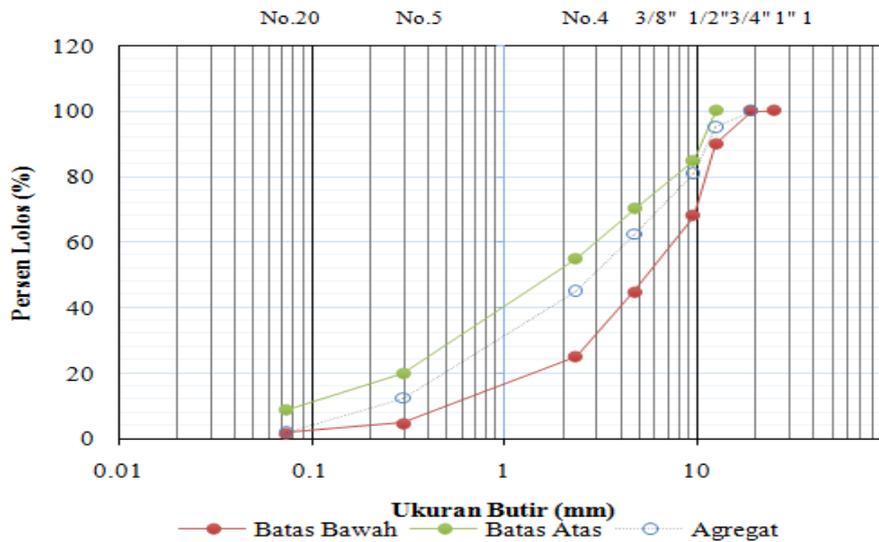
**Gambar 1. Gradasi agregat gabungan**
