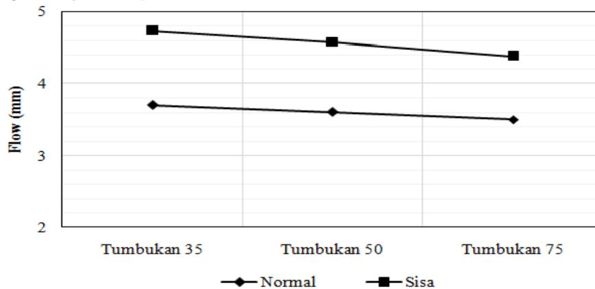
**Gambar 6. Hubungan antara jumlah tumbukan dan campuran aspal emulsi dengan Flow**
