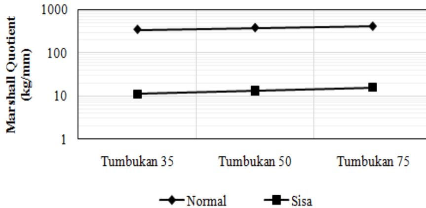
**Gambar 7. Hubungan antara jumlah tumbukan dan campuran aspal emulsi dengan Marshall Quotient**
